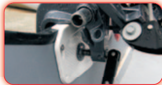
▲ регулировка высоты транца
